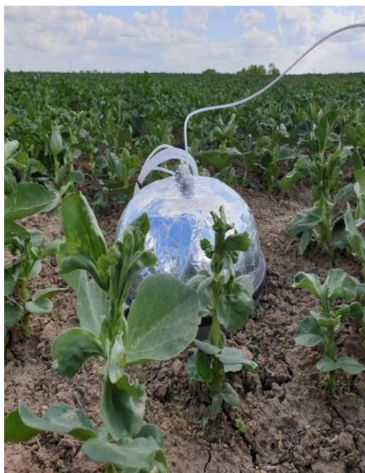
Att. 12. Kamera gāzu mērījumu veikšanai 6 .
