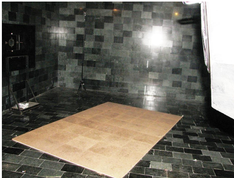
7. attēls. Kaņepju šķiedru plāksņu izvietojums Reverberācijas kamerā.
