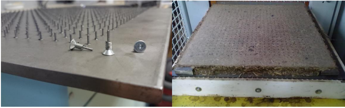
7. att. Plātņu ar caurumiem presēšanas veidnis (a) un izgatavota plātne (b).
