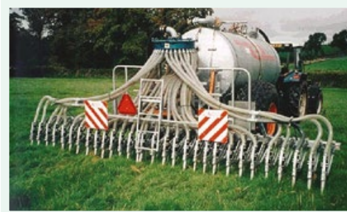
Agregāts šķīdumslu ievadīšanai augsnes virskārtā. Avots: ZSA arhīva materiāli
