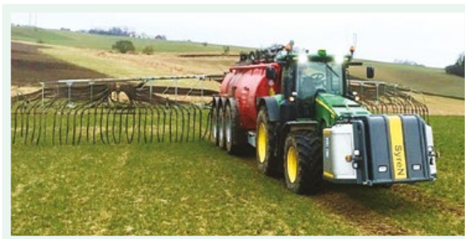
Paskābinātu šķidrmēslu iestrādes agregāts 30–40 cm garā zelmenī.
