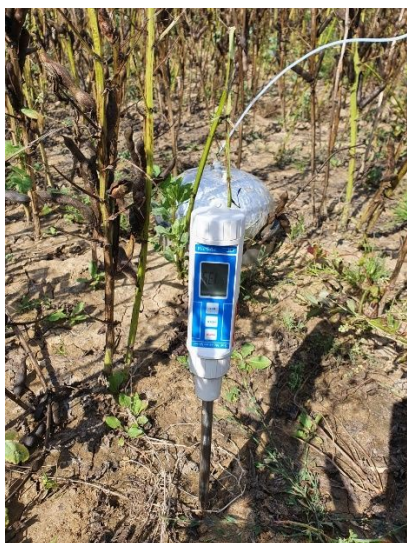
Att. 4. Augsnes mitruma mērītājs (autors: J. Pilecka).
