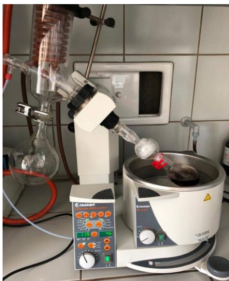
17. atēls. Augu ekstraktu pagatavošana ar rotācijas ietvaicētāju.
