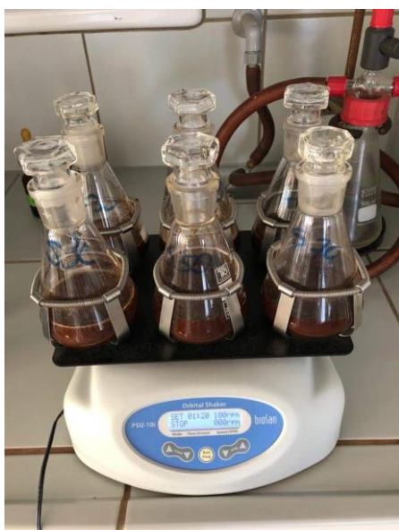
16. attēls. Augu ekstraktu sagatavošana ar kratītāju un nofiltrēti paraugi.
