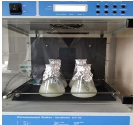
3.3. att. Paraugu fermentācija inkubatorā, kas aprīkots ar maisīšanas funkciju
