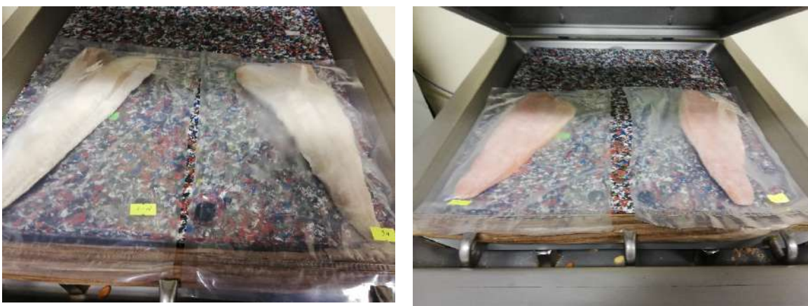
39. attēls. Saldētu zivju fileju hermētiska iepakojšana polimēru iepakojumā
