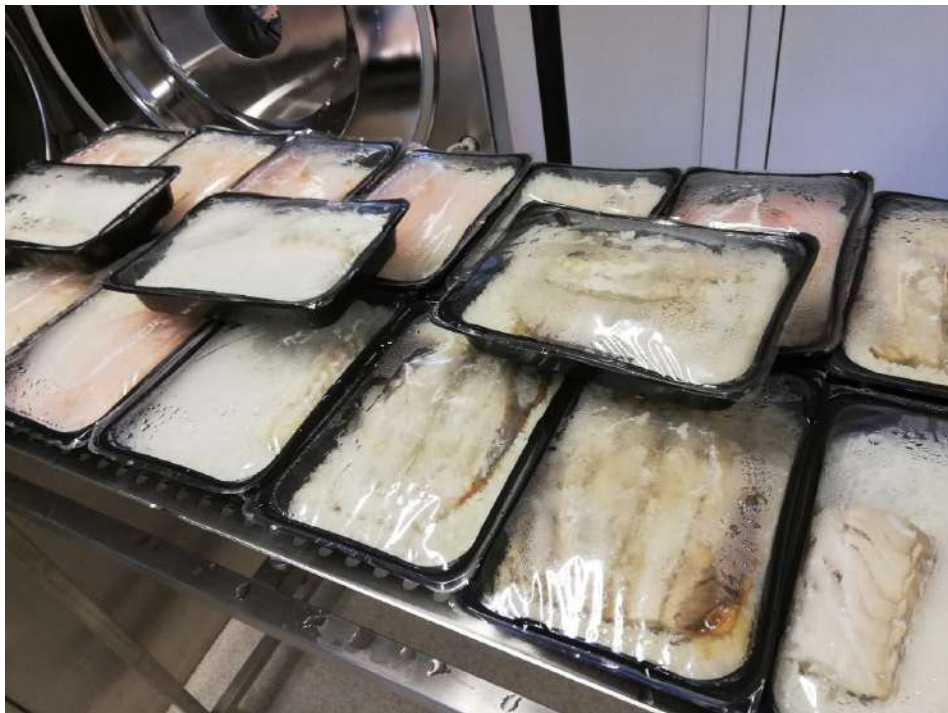
14. attēls. Hermētiski aizkausēti iepakojumi (mencas, makreles un foreles filejas gaisa vidē) pēc termiskās apstrādes, paraugus izņemot no autoklāva 85 °C temperatūrā
