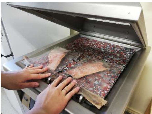
18. attēls. Zivju fileju iepakojšana termoizturīgajos PE/PA iepakojumos kameras tipa iekārtā “MULTIVAC”
