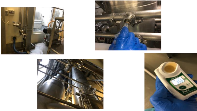
10. att. Koncentrāta ieguve lejupejošā slāņa ietvaices iekārtā, sadarbībā ar AS 'Smiltenes piens'.
