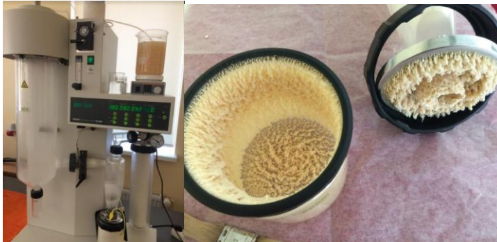
6. att. Vertikālā izsmidzināšanas kalte un dehidrāts
