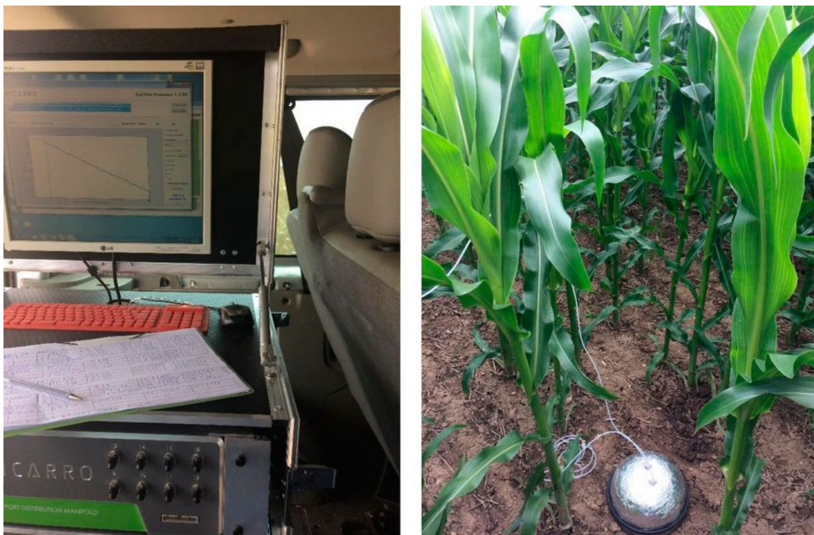
Att. 25: Picarro G2508 un kamera gāzu mērījumu veikšanai (J. Pilecka).
