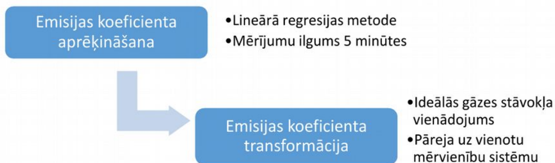
Att. 27: Gāzu koncentrāciju mērījumu transformācijas aprēķina algoritma shematiskais attēlojums.
