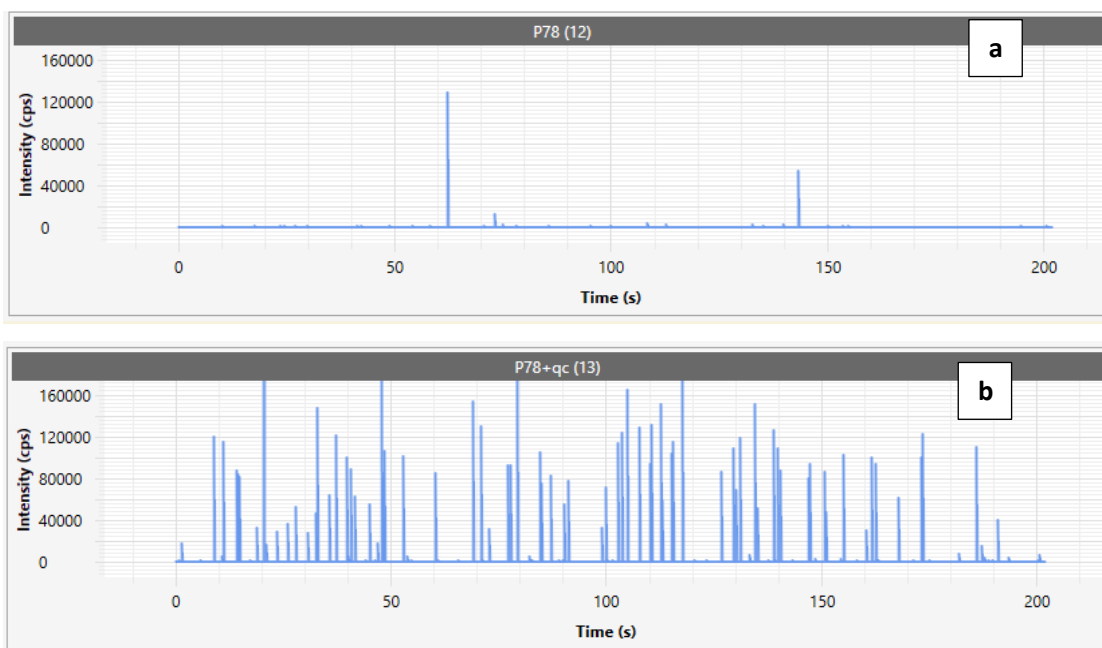
2.6. att. Sudraba nanodaļiņu hromatogrammas ar SP-ICP-MS instrumentāciju: a - P78 (cukura lodītes: Ag = 16,2 mg/kg), b - P78 ar 2.5 ng/L standartpiedevu
