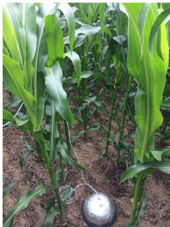
13. att. Kamera gāzu mērījumu veikšanai (autors: J.Pilecka).
