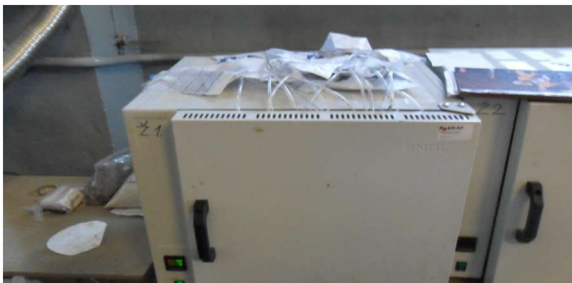
6. attēls. Žāvēšanas skapis biogāzes potenciāla pētīšanai.
