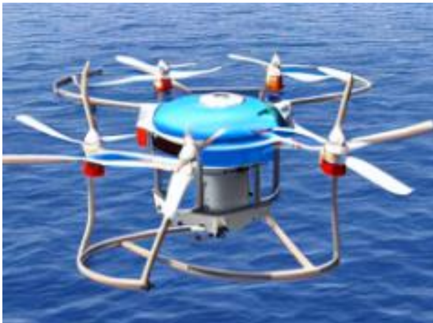
6.1.6 Sešmotoru drons ar integrētu toroidālu H2 krātuvi – telpiskais 3D modelis
