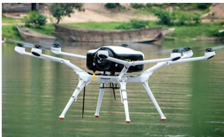
4.3. att. Firmas Doosan Mobility Innovation ūdeņraža FC drons DS30W
