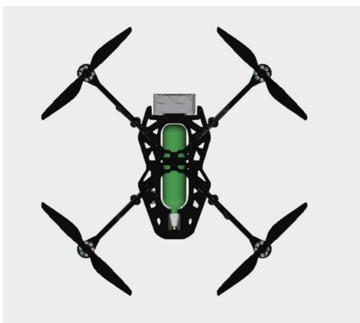
3.11. att. Četrmotoru drons ar integrētu cilindrisku H2 krātuvi - finālversija
