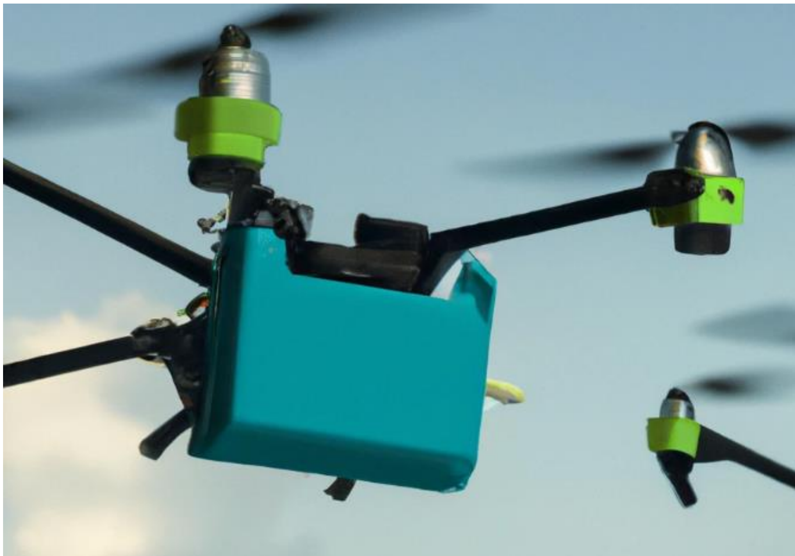
6.1.8 Četrmotoru drons ar integrētu toroidālu H2 krātuvi – telpiskais 3D modelis (variants)
