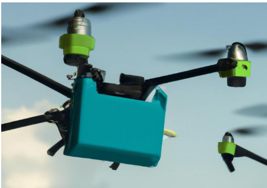
3.9. att. Četrmotoru drons ar integrētu cilindrisku H2 krātuvi – telpiskais 3D modelis (2.variants)
