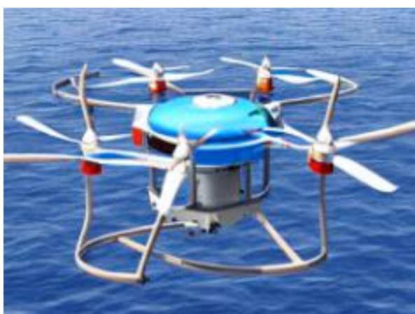
3.7. att. Četrmotoru drons ar integrētu toroidālu H2 krātuvi – telpiskais 3D modelis
