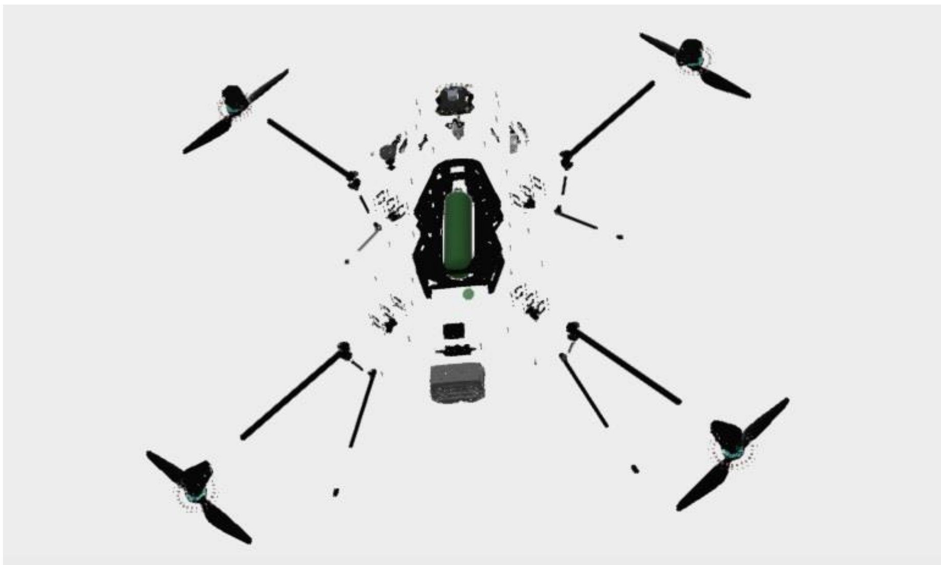
6.1.9 Strukturāls detaļu izvietojums – četrmotoru drons ar integrētu cilindrisku H2 krātuvi
