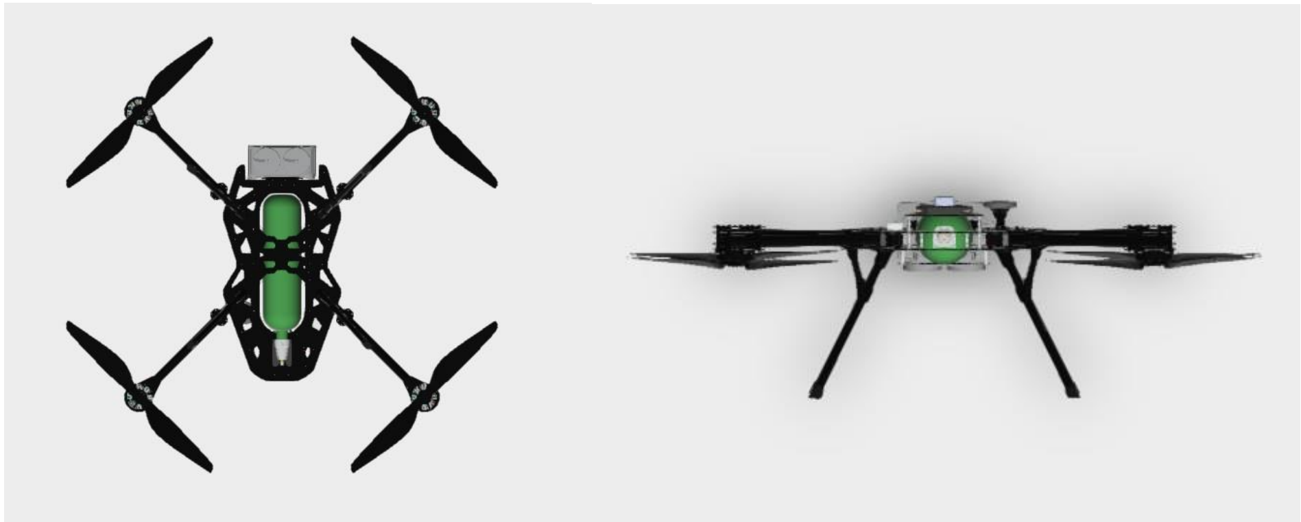
6.1.10 Četrmotoru drons ar integrētu cilindrisku H2 krātuvi - finālversija
