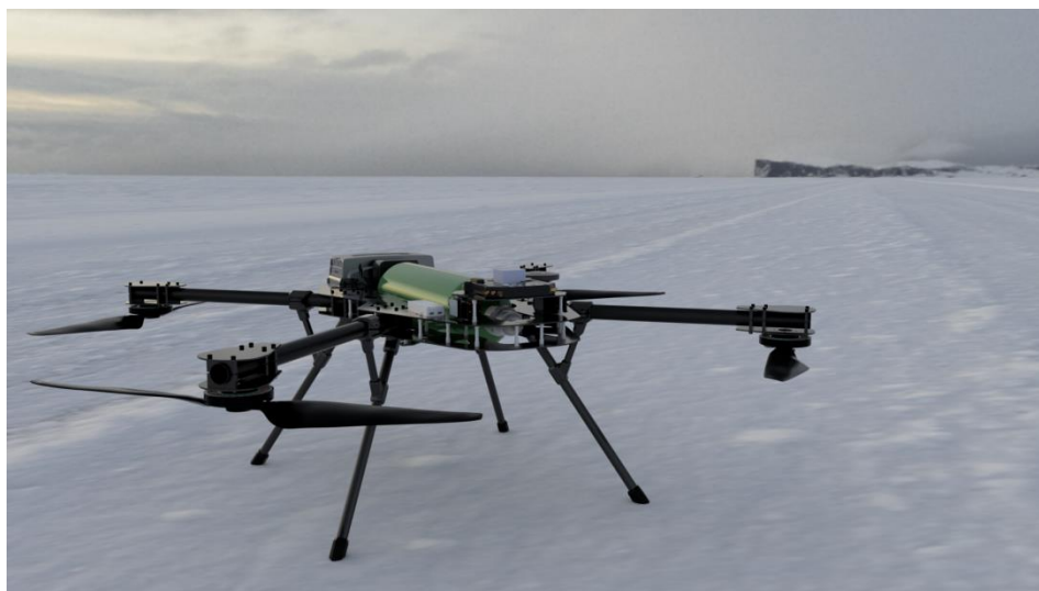
3.12. att. Četrmotoru drons ar integrētu cilindrisku H2 krātuvi - finālversija – virtuālā vide
