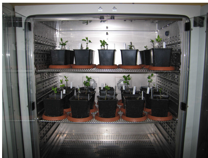
1.1.1.attēls. Inkubators augu termoterapijai.
