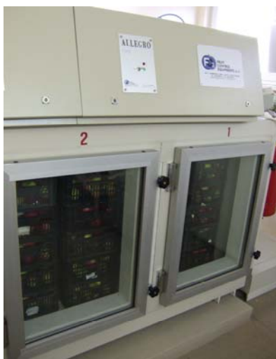
5.4.1. att. Eksperimentālās ULO augļu uzglabāšanas kameras
