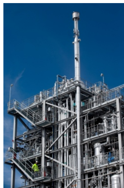
4-6.att. Melnā atsārma gazifikācijas iekārta BioDME ražošanai, Svenskt Förgasningscentrum
